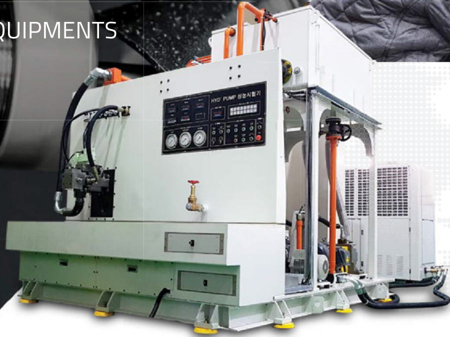
PISTON PUMP 성능시험장치
