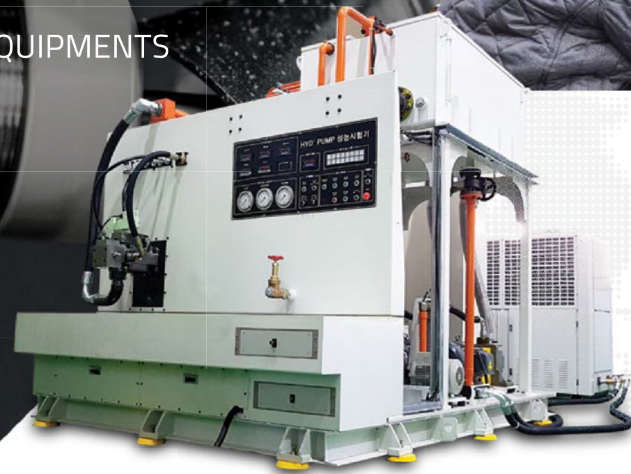
柱塞泵性能试验装置
